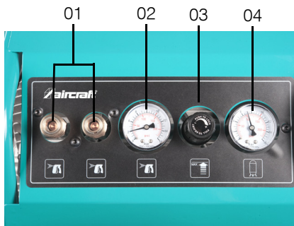
Abb. 4: Bedienfeld der COMPACT-AIR Kompressoren
