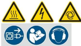
Fig. 1: Símbolos de seguridad en el compresor
