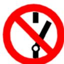
Desconecte la sierra de cinta para metal de la alimentación de tensión y séguela para que no se produzca un nuevo encendido.
