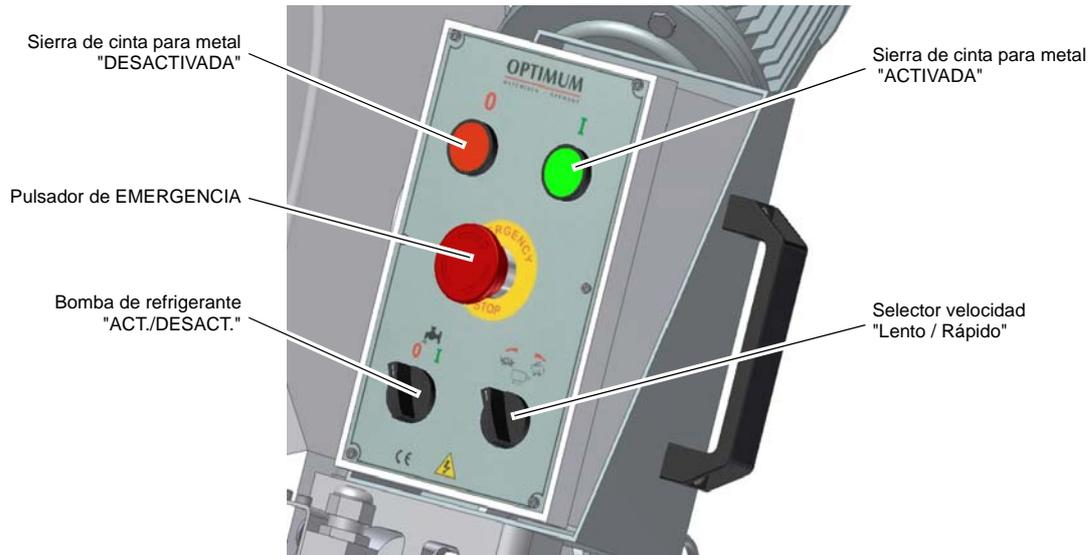
Fig.5-2: Panel de control de la sierra de cinta para metal
