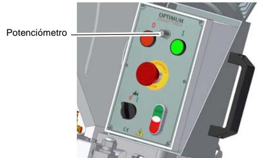
Fig. 4-7: Potenciómetro S210G Vario/ S275G Vario
