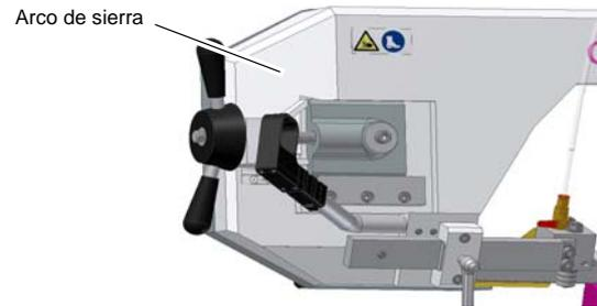
Fig. 1-2: Carcasa de la cinta de sierra con tapa de protección
