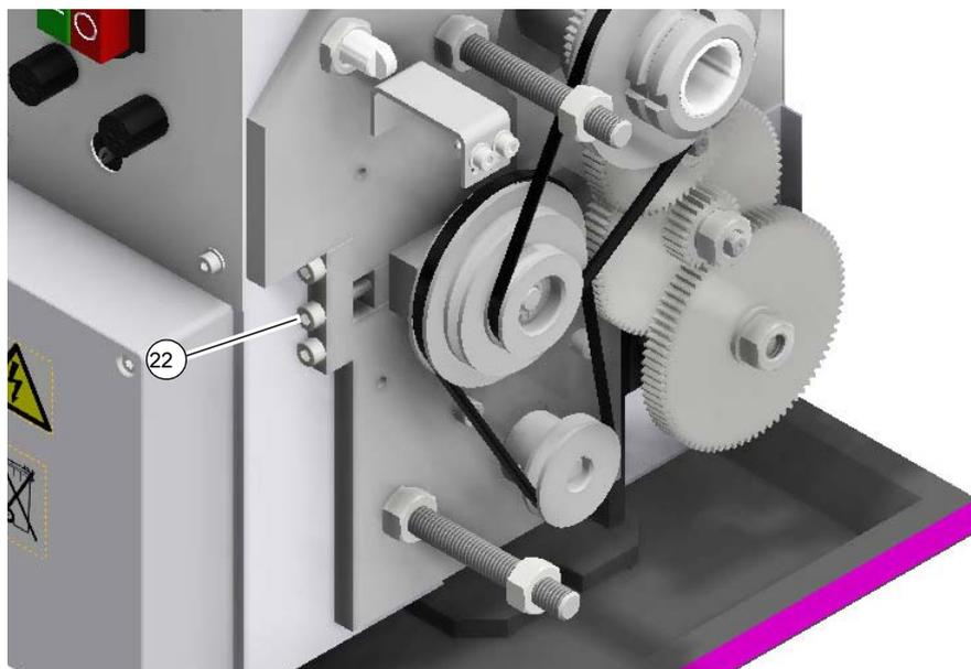
Img.4-7: Cambio de posición de la correa sincrónica
