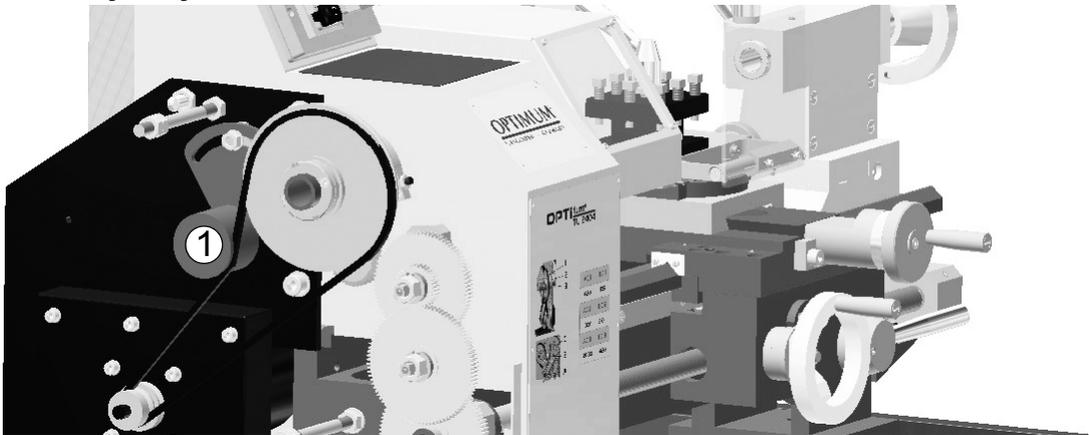
Img.4-4: Polea tensora
