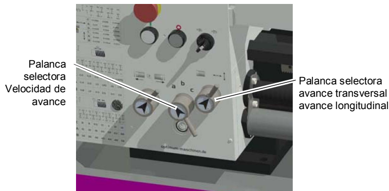
Imagen 4-5: Cambio de velocidad de avance
