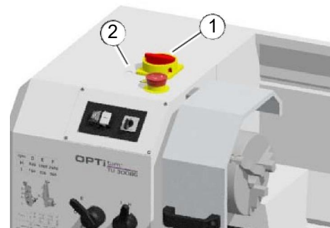
Interruptor principal y seta de emergencia
