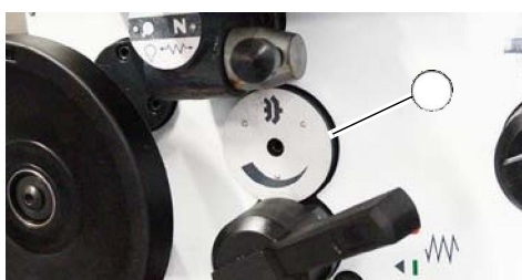
Ajuste del embrague del avance
