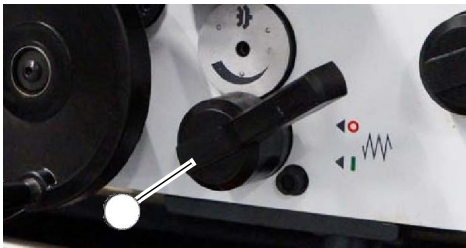
Palanca ON corte avance longitudinal
