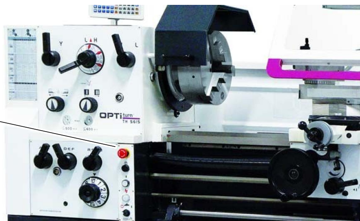
Img.1-2: Pulsador PARO DE EMERGENCIA
