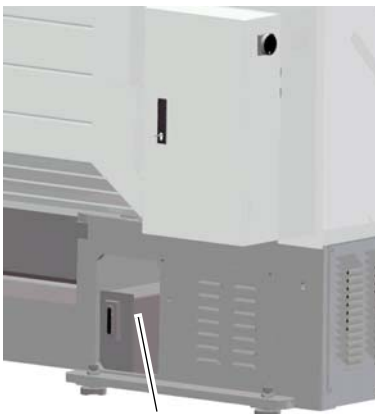
Img.3-1: Lubricación central del tanque
