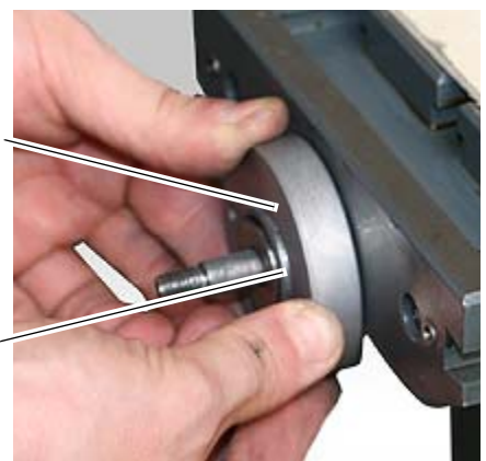
Fig.6-3: Anillo de montaje
