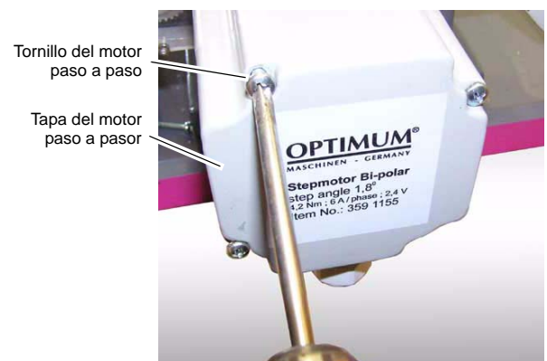
Fig.7-1: Abrir la tapa del motor paso a paso
