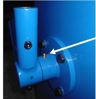
Fig.7-1: Engrasador para palanca manual
