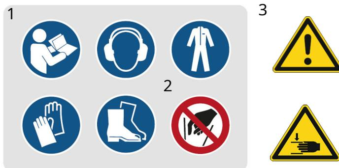
Figura 1-1: Marcas de seguridad - 1 Señal de obligación: Seguir las instrucciones de uso, Usar protección auditiva, Usar ropa protectora, Usar protección para las manos, Usar protección para los pies, 2 Señales de prohibición: Prohibido alcanzar | Señal de advertencia: señal de advertencia general, advertencia de lesiones en las manos.
