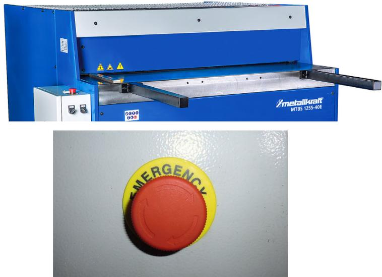
Fig. 2: dispositivos de seguridad en la máquina
