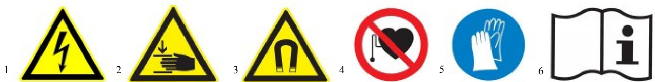
Fig. 1: Marcados de seguridad - 1 Advertencia de tensión eléctrica | 2 Peligro por riesgo de aplastamiento | 3 Precaución por campo magnético fuerte | 4 No deberán permanecer en el área personas con marcapasos | 5 Llevar guantes de protección | 6 Leer el manual de instrucciones
