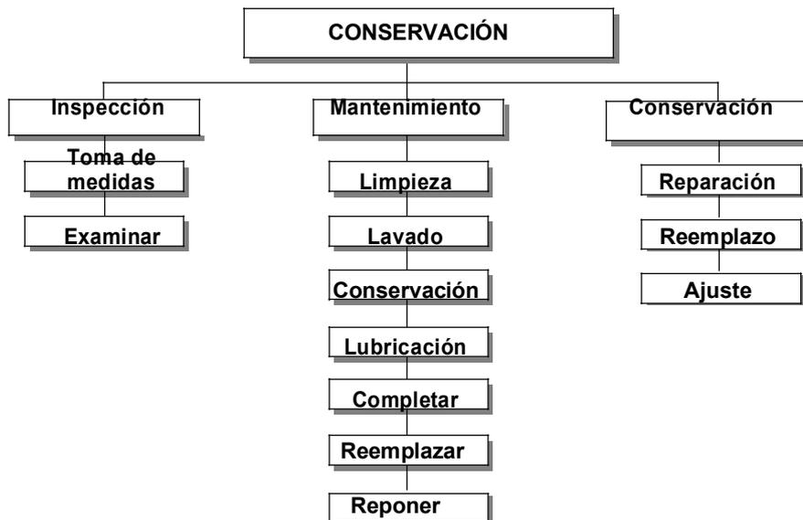
Imagen 5-1: Mantenimiento – Definición según DIN 31051
