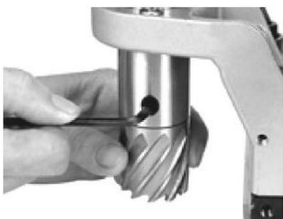
Fig. 12: Montaje de la broca sacanúcleos
