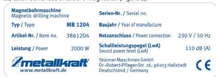
Fig. 2: Placa de características y símbolo CE en la máquina perforadora de núcleo magnético MB 1204
