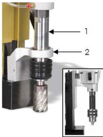
Fig. 15: Montaje del mandril
