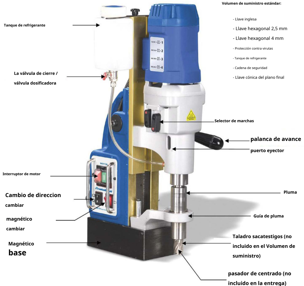
Fig. 7: Elementos de mando de la máquina perforadora de núcleo magnético MB 754
