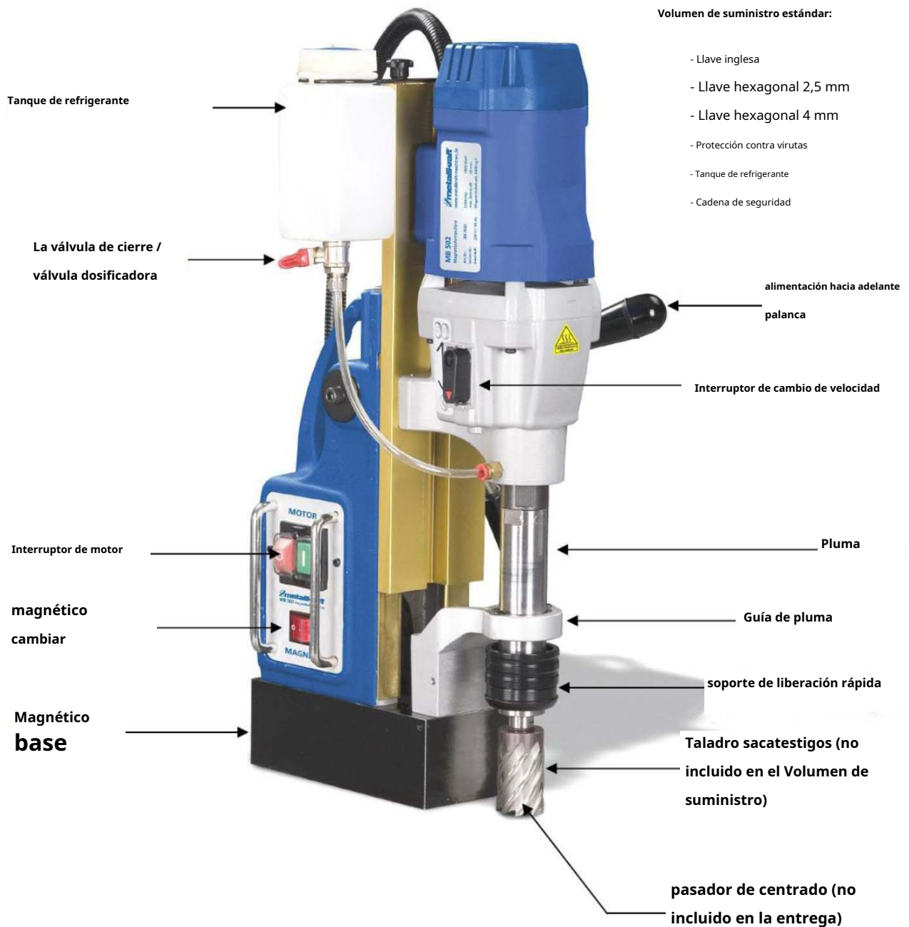
Higo. 5: Elementos de mando de la máquina perforadora de núcleo magnético MB 502
