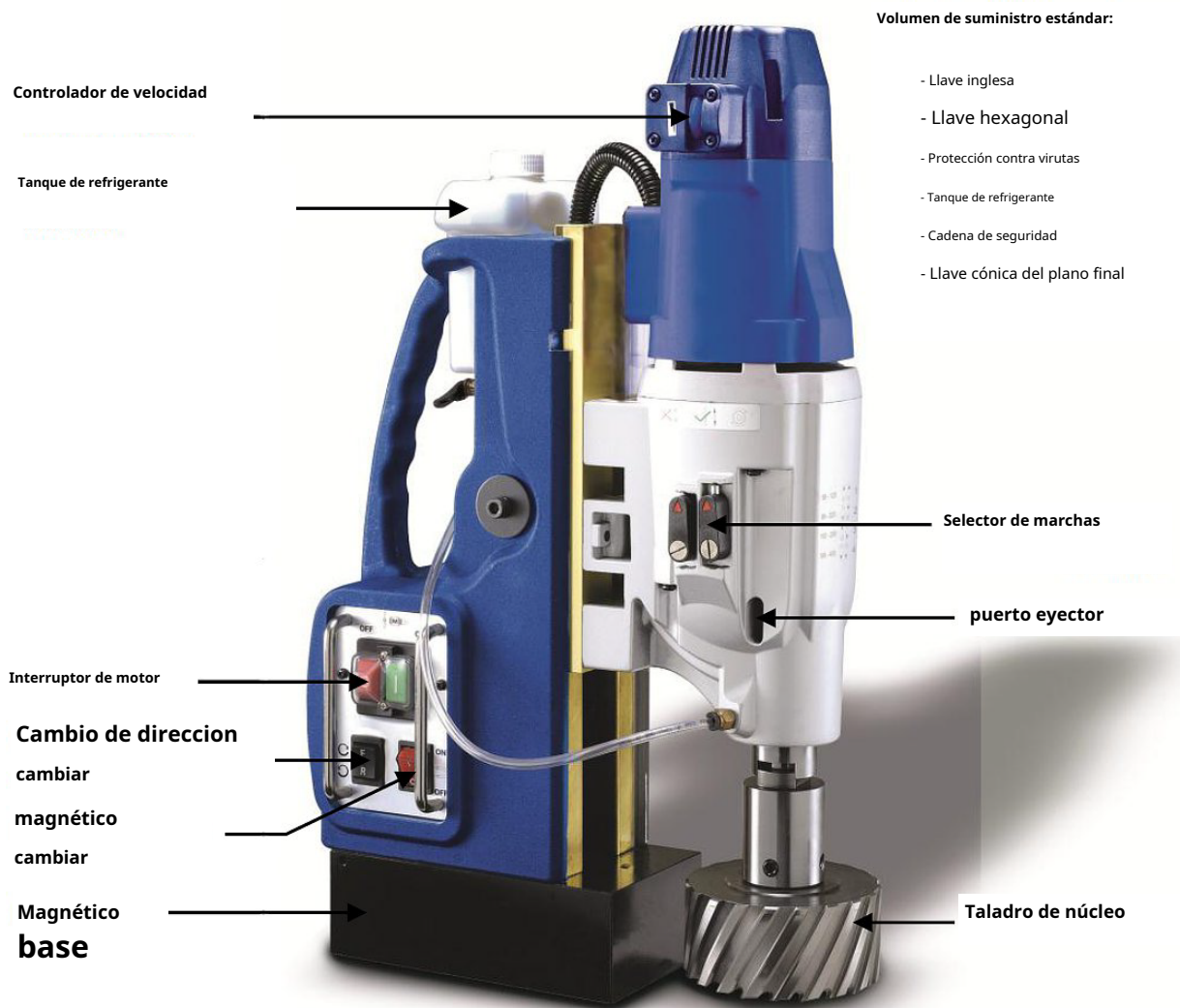
Fig. 8: Controles de la máquina perforadora de núcleo magnético MB 1204
