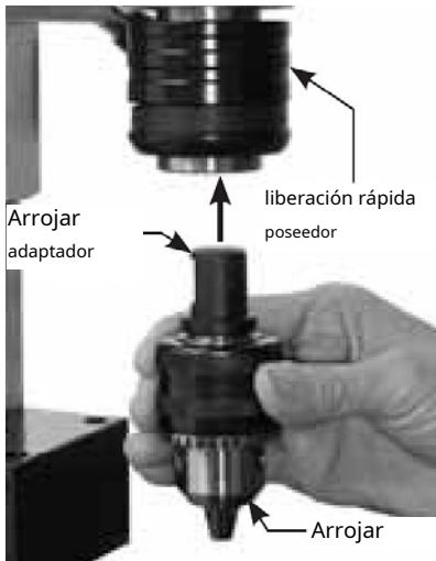
Fig. 16: Montaje del portabrocas de cambio rápido
