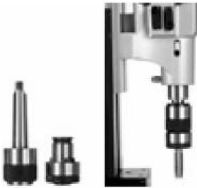
Fig. 21: Construcción para roscar
