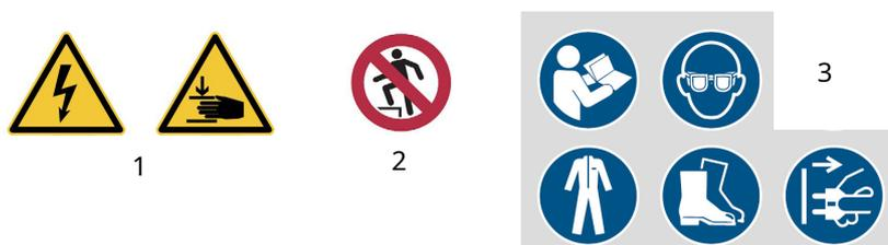
Fig. 1: Identificaciones de seguridad - 1 señal de advertencia: Peligro alto voltaje, peligro de aplastamiento para la parte superior extremidades | 2 Señal de prohibición: No entrar | 3 Señales obligatorias: Lea el manual de instrucciones, desconecte el enchufe de red, use protección para los ojos, ropa de seguridad, use zapatos de seguridad
