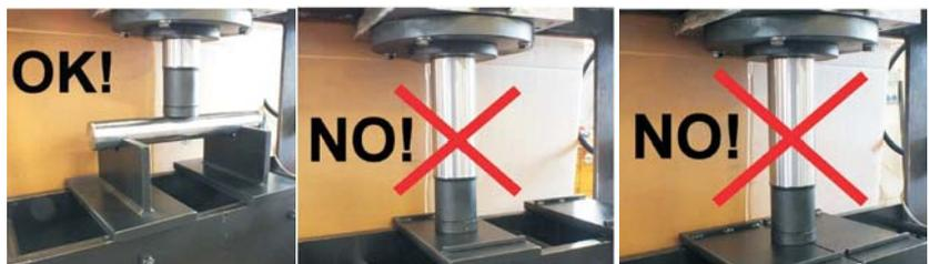
Fig.11: Colocación de la pieza de trabajo
