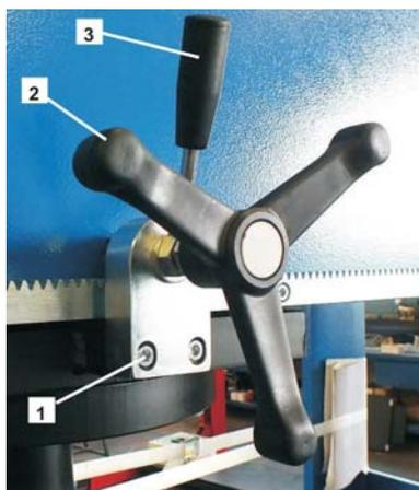
Fig.7: Montaje del volante
