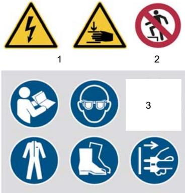
Fig. 1: Identificaciones de seguridad - 1 Señal de advertencia: Peligro de alta tensión, peligro de aplastamiento de las extremidades superiores | 2 Señal de prohibición: no entrar | 3 Señales de obligación: leer el manual de instrucciones, desenchufar el enchufe de red, usar protección para los ojos, ropa de seguridad, llevar calzado de seguridad
