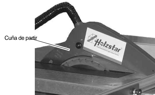
Fig. 1-1: Cuña de partir y protector de sierra
