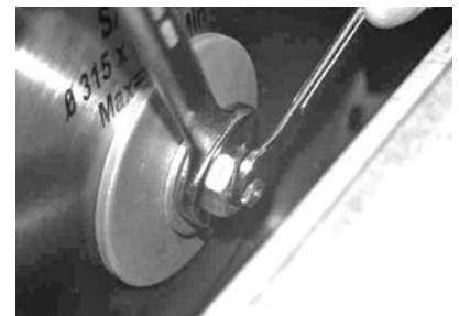
Fig.2-12: Disposición hoja de sierra - bridas
