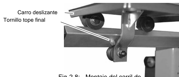
Fig.2-8: Montaje del carril de rodadura y el carro deslizante
