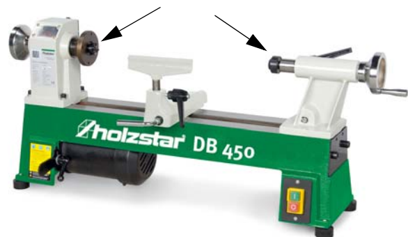
Fig.6: Desengrasar los soportes cónicos
