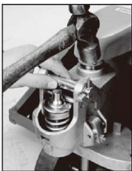
Fig. 7: pasador de seguridad Insertar
