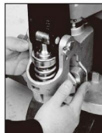
Fig. 12: Inserción de la cadena en la leva
