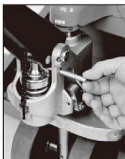
Fig. 9: bloqueo de seguridad Remove
