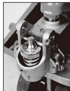
Fig. 5: Comprobación del perno de seguridad
